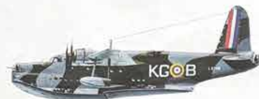
Britse Short Sunderland Mark I — vliegboot Bewapening: Drie 7,7 mm Vickers K machinegeweren en twee bommen van 225 kg of acht bommen van 112,5 kg. Snelheid: 335 km/u op een hoogte van 1000 meter. Vliegbereik: Maximum 4.540 km. Bemanning: Maximum 10.
