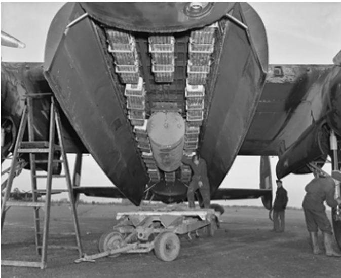
Het bommenruim van een Lancaster, gevuld met één cookie en een aantal SBC's (Small Bomb Containers) gevuld met brandbommen van 4 lb. Eén SBC bevatte ongeveer 60 van deze kleine brandbommen. De Lancaster kon, naast de cookie, 14 SBC's meenemen. (bron: IWM)
