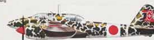
Japanse Kawasaki Ki-45 Kaic "Toryu" (Drakendoder) — zwaar gevechtvliegtuig Bewapening: Drie 30 mm Ho 203 kanonnen met 250 kg Type 1 Ho 203 kanonnen en twee bommen van 250 kg. Snelheid: 537 km/u op 8000 meter hoogte. Vliegbereik: 1050 kilometer. Bemanning: 2.
