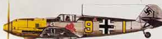
Duitse Messerschmitt Bf 109E-3 — eenmans jachtvliegtuig Bewapening: Twee 20 mm MG FF kanonnen met 80 schoten per stuk en twee 13 mm MG 12 machinegeweren met 1500 schoten in de vleugels en twee 20 mm MG FF/M met 200 schoten in de staart. Snelheid: 557 km/u op een hoogte van 4440 meter. Vliegbereik: 856 km.
