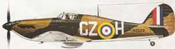
Britse Hawker Hurricane I — eenmans jachtvliegtuig Bewapening: Acht 7,7 mm Browning machinegeweren met 234 schoten per wapen. Snelheid: 518 km/u op een hoogte van 5000 meter. Vliegbereik: 815 kilometer.
