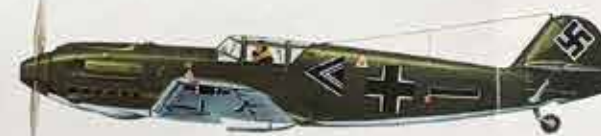
Duitse Messerschmitt Bf 109D — eenmans jachtvliegtuig Bewapening: Twee 7,6 mm MG 12 machinegeweren met 500 schoten elk en twee 20 mm MG FF kanonnen met 160 schoten. Snelheid: 571 km/u op 3.900 meter hoogte. Vliegbereik: 560 km.
