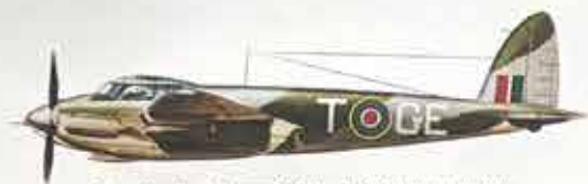
Britse Havilland Mosquito VI — jachtbommenwerper Bewapening: Vier 20 mm Hispano kanonnen met elk 150 schoten en vier 7,7 mm machinegeweren, plus een bommenlading van 300 kg of 450 kg en acht raketten van 27 kg. Snelheid: 400 km/u op een hoogte van 6.000 meter. Vliegbereik: 2500 kilometer. Bemanning: 2.
