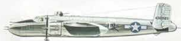
Amerikaanse B-25J - Mitchell — gevechtvliegtuig Bewapening: Acht 12,5 mm Browning machinegeweren in de neus, twee 7,7 mm MG 12 machinegeweren in de vleugels en twee 20 mm MG 12 machinegeweren in de staart. Snelheid: 440 km/u op 4.000 meter. Vliegbereik: 2.900 km. Bemanning: 5.
