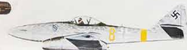
Duitse Messerschmitt Me 262A-1a jager "Schwalbe" (Zwaluw) Bewapening: Vier 30 mm Rheinmetall-Borsig MG 151 kanonnen met elk 100 schoten per stuk plus twee bommen van 500 en 300 kg. Snelheid: 957 km/u op een hoogte van 8000 meter. Vliegbereik: 1050 kilometer.
